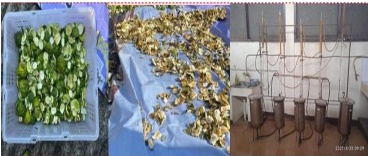
Gambar 1 Proses pembuatan minyak kulit jeruk purut
